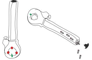
Questi cosi rossi sono gli *shear pins*, 2 a volte 3, dipende dal modello. Prima di smontare la leva fai un segno perché, intelligentemente, non sono regolari e se perdi la posizione della leva poi non combacia niente e scleri.
